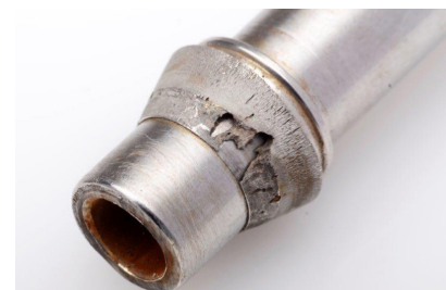
Abbildung 1. Diese Doppelklemmringverschraubungen – aus Edelstahl 316 – wurden aus einem 6MO-Rohr entfernt, die seit rund neun Monaten im Offshore-Bereich im Einsatz war. Sie verdeutlichen die potenziellen Probleme, wenn die Entscheidung für bestimmte Verschraubungen allein aus Kostengründen getroffen wird.
