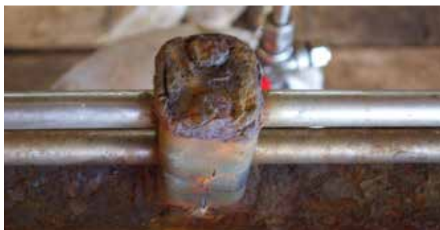
Spaltkorrosion an der Rohr/Abscheider-Schnittstelle.
