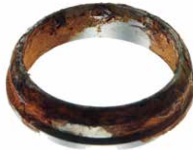
Nitriergehärteter hinterer Klemmring
