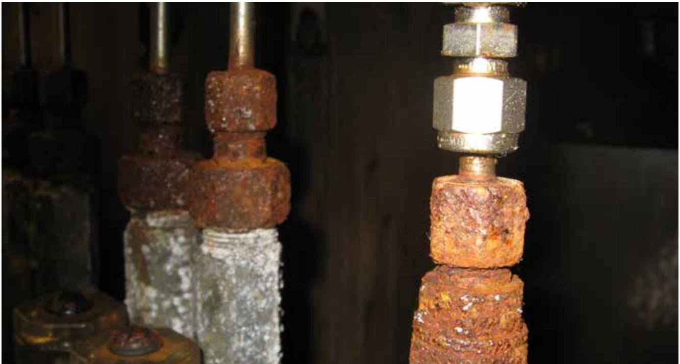
Galvanische Reaktion durch Kombination von verschiedenen Materialien für Verschraubungskörper und Überwurfmutter.
