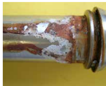
Abbildung eines Niedrigkostenprodukts. Korrosionsschaden durch eine minderwertige Härtung des hinteren Klemmrings
